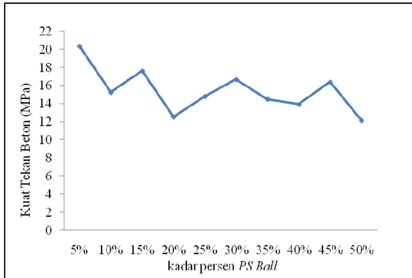
Gambar 8. Pengujian kuat Tekan Beton Dengan Menggunakan PS Ball Sebagai Pengganti Pasir Pada umur 3 Hari.
