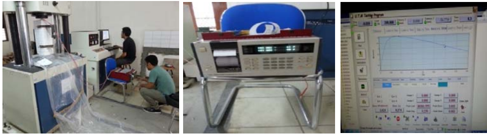
Gambar 6. Alat uji tekan, data logger dan grafik pada monitor
