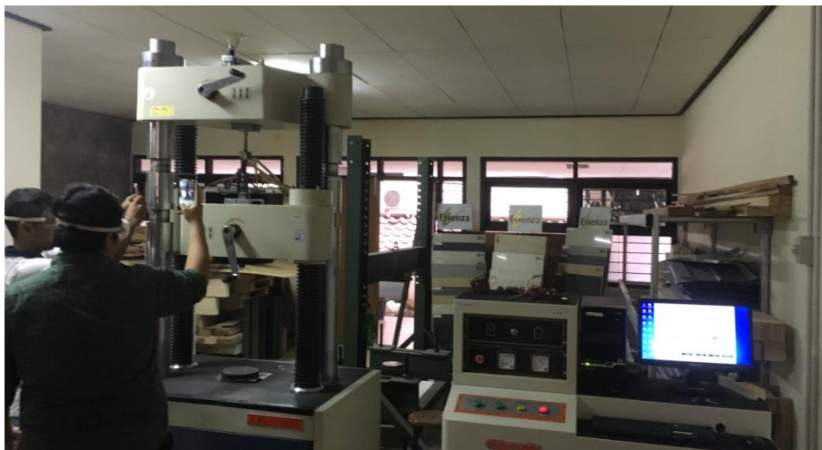
Gambar 1. Universal Testing Machine untuk pengujian tarik sambungan baja
