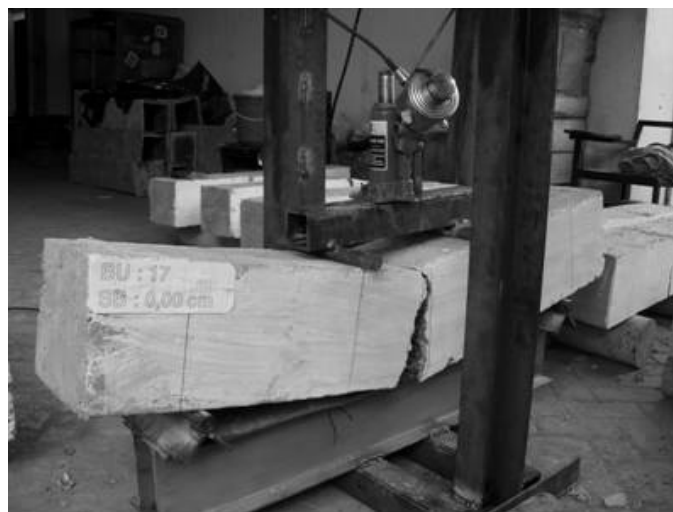
Gambar 8. Kegagalan balok dengan panjang sambungan lewatan tulangan L_d = 0 .
