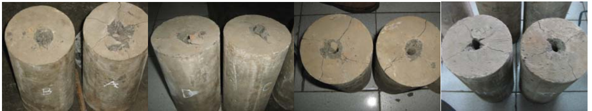
Gambar 4. Kegagalan panjang penjangkaran 50, 100, 150 mm, dan 200 mm (tulangan tercabut, beton utuh)
