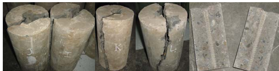
Gambar 5. Kegagalan panjang penjangkaran 250 dan 300 mm (tulangan tercabut, beton terbelah)
