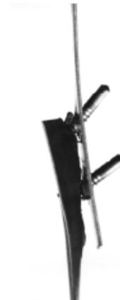
**Gambar 9 Keruntuhan *Tilting* & *Pull-Over* [Dunai et all, 2004].**
